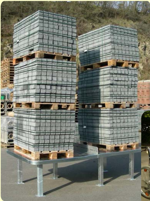
Belastungstest mit rund 10 to Pflastersteinen. Tatsächlich hält der Tisch deutlich mehr aus,
